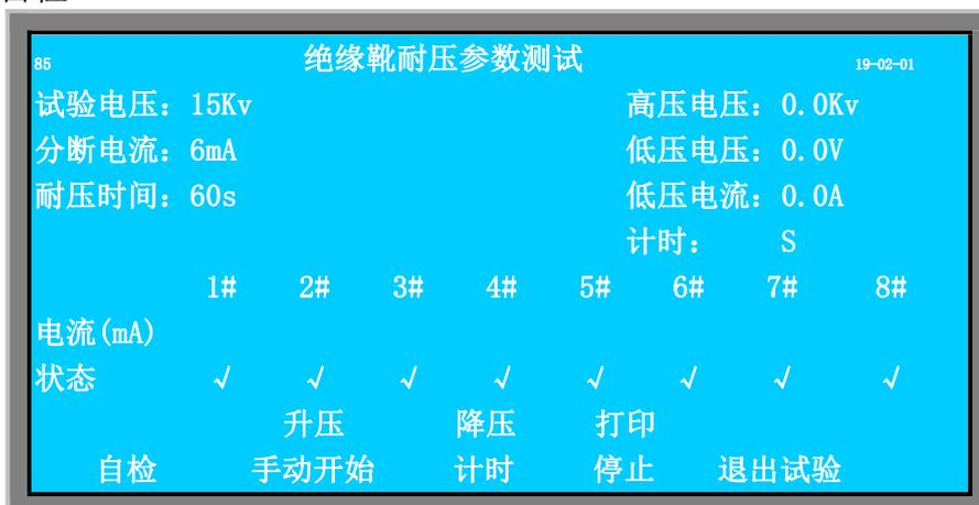
点击“自检”键后，绝缘支架的脱扣通道依次断开，出现脱扣不了应该检查该通道。该通道损坏，联系厂家维修。
